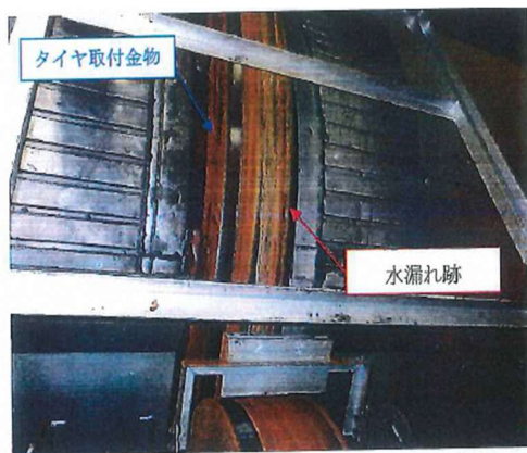
写真1 クラックによる漏水跡
